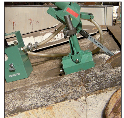
Uchwyt magnetyczny do cięcia sworzni obudowy zmechanizowanej
