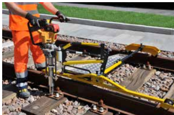
Akumulatorka wiertarka SD-19BR z wózkiem CS-EU
